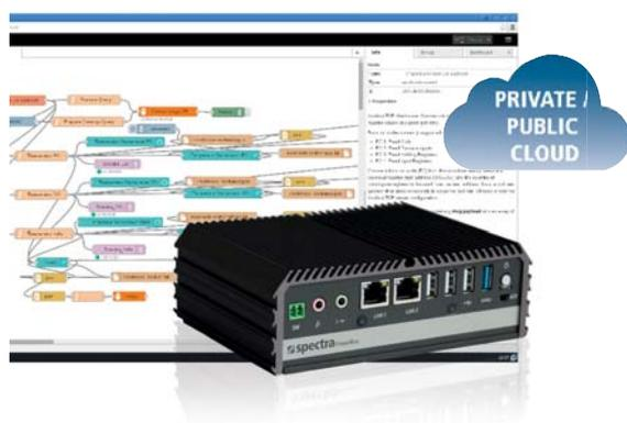
Ein Edge-PC ist mit Intelligenz ausgestattet. Installierte IIoT-Programme wie Node-RED sammeln die Daten aus der Feldebene (OT) auf und senden diese vorverarbeitet und verdichtet in die private/public Cloud (IT).
